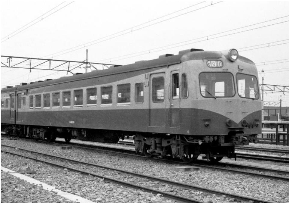
1957（昭和32）年度以降に製造されたか86形300番台の車両は全金属製になりました。か86形は合わせて200両製造されました。か86310号車、1957（昭和32）年度製。新前橋電車区にて。
